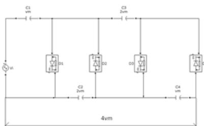
Fig 1.1.Voltage Quadrupler
