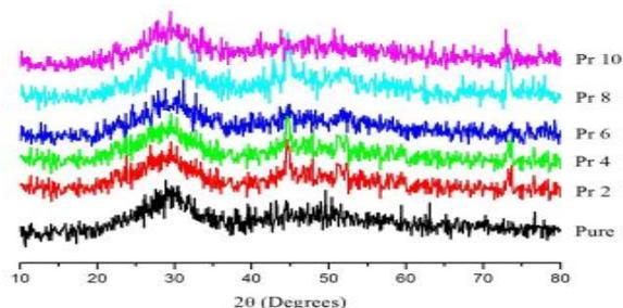
**Fig.2. XRD spectra of  $\text{CaO-PbO-B}_2\text{O}_3\text{-SiO}_2\text{: Pr}_2\text{O}_3$  glasses**
