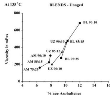
**Figure 4(c) Asphaltenes Vs. 135 °C Viscosity**
